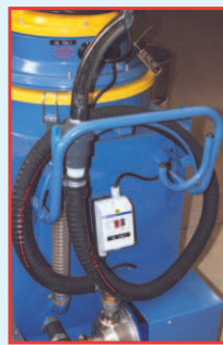
Manico di spinta, tubo di scarico con valvola a sfera Mango de empuje, tubo de descarga con válvula sferica
