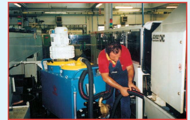
Aspirazioni di liquidi e trucioli su tornio automatico. Aspiración de líquidos y virutas sobre torno automático.
