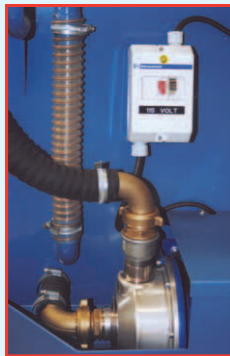
Pompa in lamierato di protezione, interruttore, indicatore di livello
